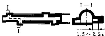
图 4-17 煤巷掘进抽放瓦斯孔布置图
