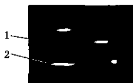
图1-10 简单结构煤层 1—煤层；2—透镜体矿物质
